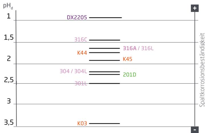
Spaltkorrosion tritt in zwei Phasen auf. In der ersten Phase (Initiation) sammelt sich Chlorid an und die Versauerung beginnt. Dies führt schließlich zur Depassivierung im Spaltbereich. Ein Depassivierungs-pH-Wert ist die kritische Bedingung für das Versagen der Passivschicht.
