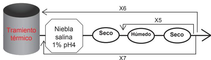
Ensayos realizados en cámara climática para simular el fenómeno de corrosión externa.
