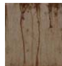
Ilustración del K41X expuesto a condiciones de carretera Duración del ciclo: 24h Duración del test: 500h Tratamiento térmico: 300°C
